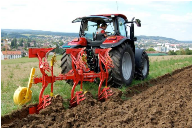
Der Onlandpflug hilft Bodenverdichtung in der Pflugsohle zu vermeiden
